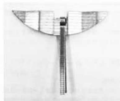
二股ピンとタイルフィックス(TF-20)の併用 (二股ピンは、張付けモルタル層の厚さが8mmを超える場合にタイルフィックスと併用する。)
